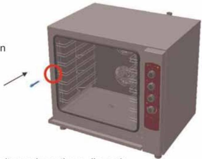
11. Entfernen Sie den mechanischen Schalter und montieren diesen in der Bedienblende an der Position der Blindschraube
