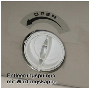
Entleerungspumpe mit Wartungskappe
