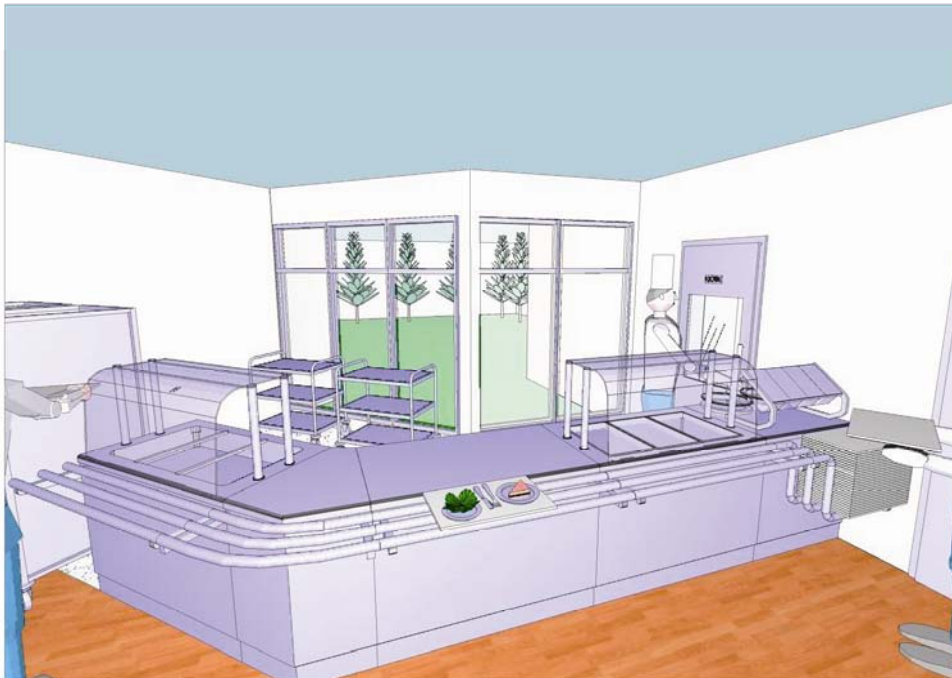
Planungsbeispiel: Betriebskantine mit Kalt- und Warmausgabe, Arbeitsplatten und Frontverkleidung aus Edelstahl
